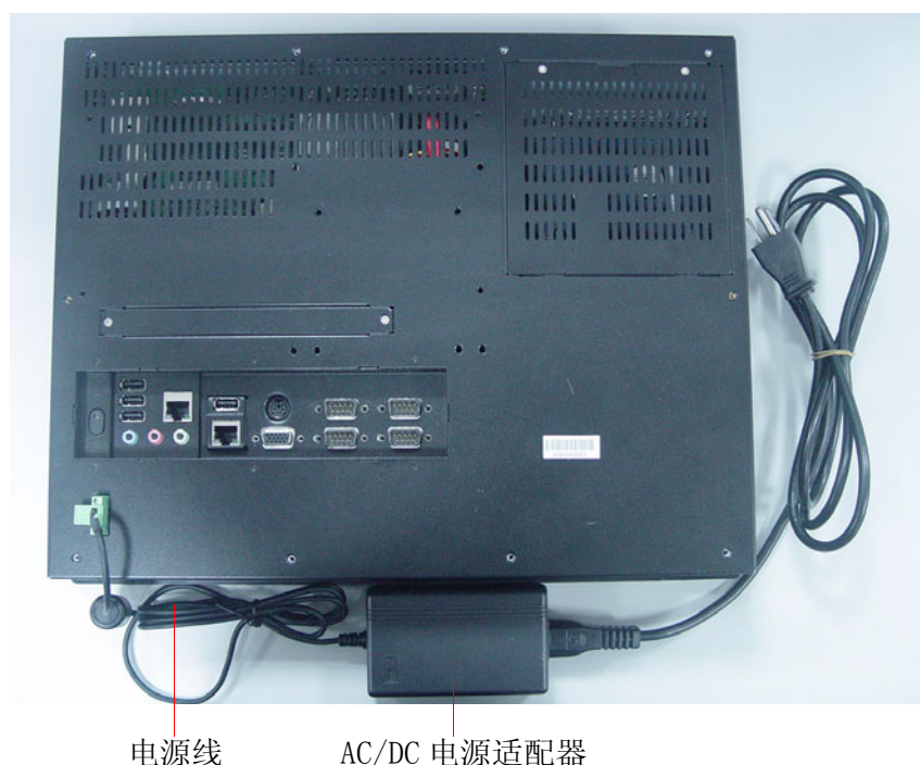
图 2.5：连接电源线与 DC 插口
